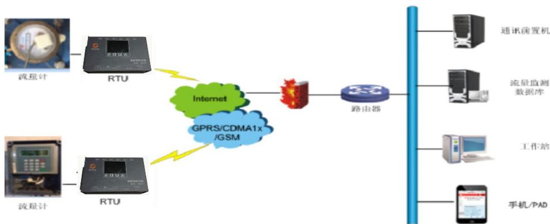
3.3.4 仪表采集要求：采集设备电源使用 220V 交流电，从流量计电源接口取电，布线为流量计到采集设备机箱；通信信号线为 RS485，从流量计表头布线到采集设备机箱。
